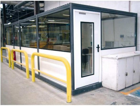
Composées d'une ossature acier et d'un habillage mélaminé blanc, nos cabines d'ateliers sont palettisables (deux passages de fourches pour chariot élévateur). Le plancher est en aggloméré 19 mm et recouvert d'un revêtement PVC multicouches. La corniche supérieure est en acier et le plafond en mélaminé blanc. Les cloisons, pleines ou demi-vitrées, ainsi que le bloc porte (ouvrante ou poussante) se positionnent selon vos souhaits.
